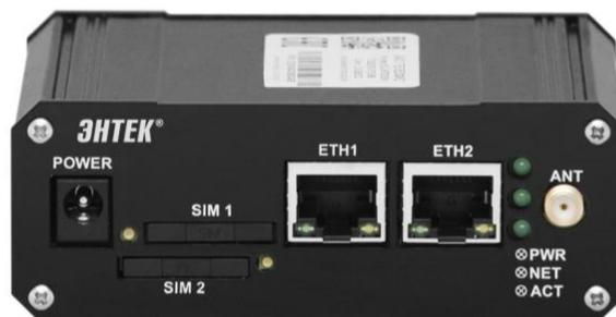
ПАК «СМАРТ-ТП» – предназначен для автоматизации учета электроэнергии, диспетчерского контроля и мониторинга состояния оборудования трансформаторных подстанций.
