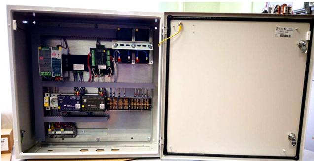
Центральная приемно-передающая станция «ЦППС ЭНТЕК-1000», это решение, состоящее из 2 процессорных шасси, выполненных на базе отечественного промышленного компьютера для установки в 19-дюймовую стойку.
